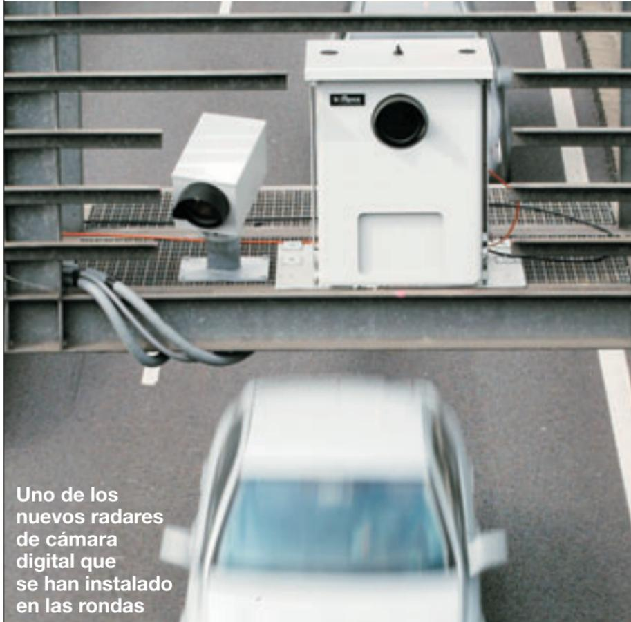
Uno de los nuevos radares de cámara digital que se han instalado en las rondas
